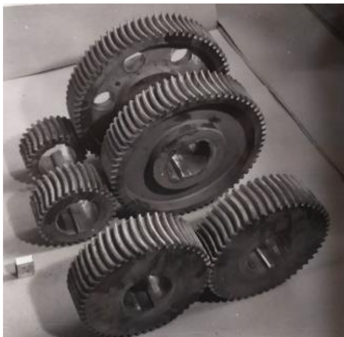
Рис. 1. Цилиндрическая передача с арочными зубьями
