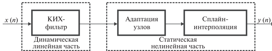
Рис. 1. Структура сплайн-адаптивного фильтра.
