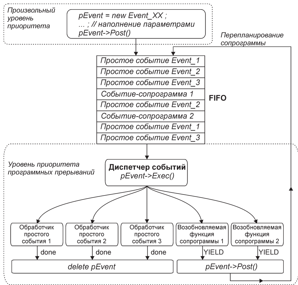
Рис. 3. Обработка простых событий и сопрограмм в системе событий. Event_XX может быть классом как простого события, так и сопрограммы.
