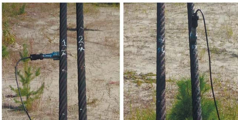
Рис. 3. Расположение вибродатчика на канате: слева — для регистрации горизонтальных колебаний; справа — для регистрации вертикальных колебаний.
