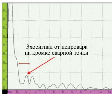
Рис. 10. А-скан, полученный на кромке сварного соединения образца № 2.
