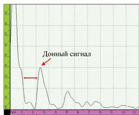
Рис. 8. А-скан, полученный на бездефектном образце.
