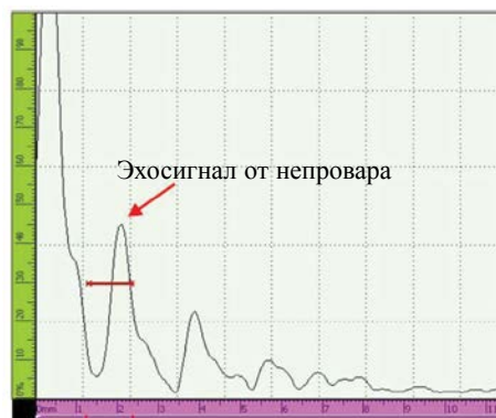
Рис. 9. А-скан, полученный на образце № 1 с непроваром.
