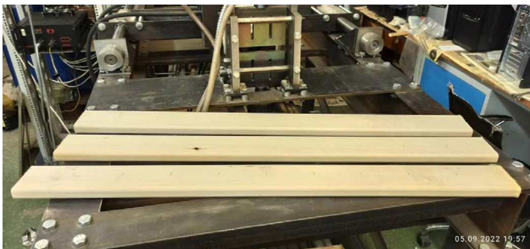
Рис. 1. Исследуемые образцы пиломатериалов перед модулем ультразвуковой обработки.
