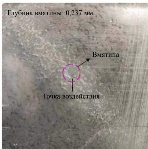
Рис. 6. Едва видимое ударное повреждение (ЕВУП).
