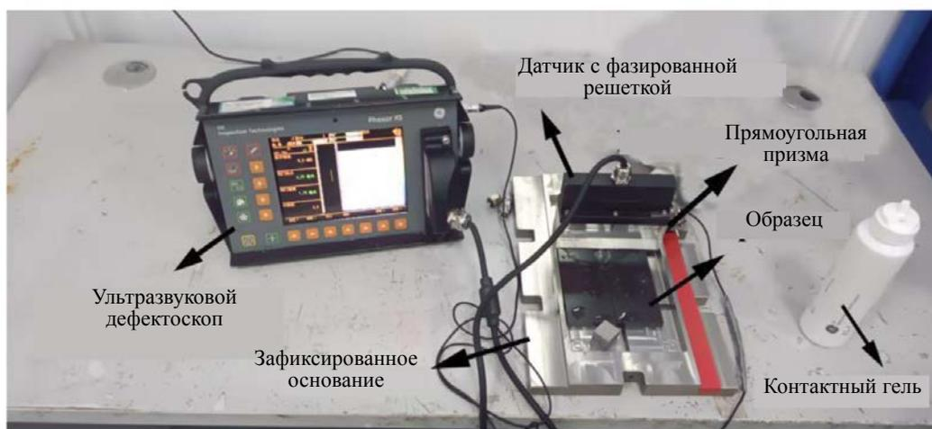
Рис. 3. Установка для ультразвукового контроля фазированными решетками.
