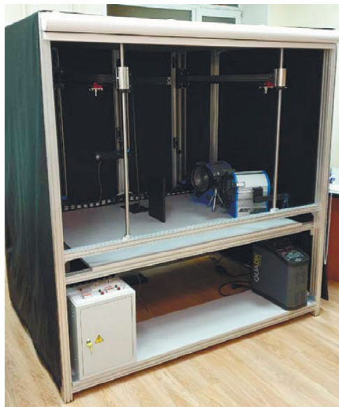
Рис. 2. Лабораторная установка теплового контроля.
