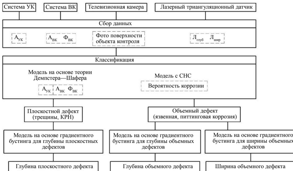
Рис. 9. Алгоритм классификации и определения размеров поверхностных дефектов.
