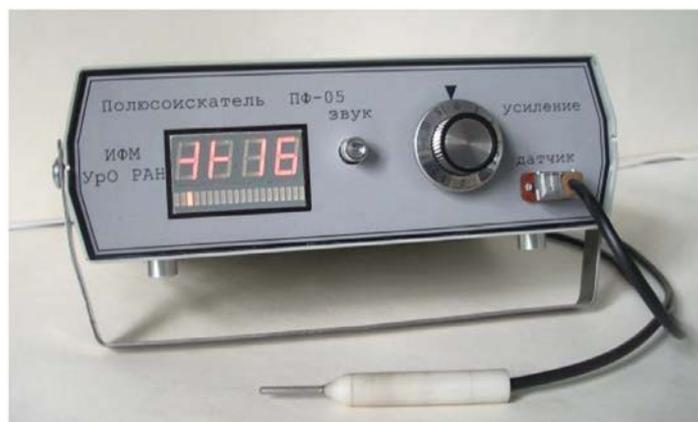
Рис. 6. Медицинский феррозондовый полюсоискатель ПФ-05.
