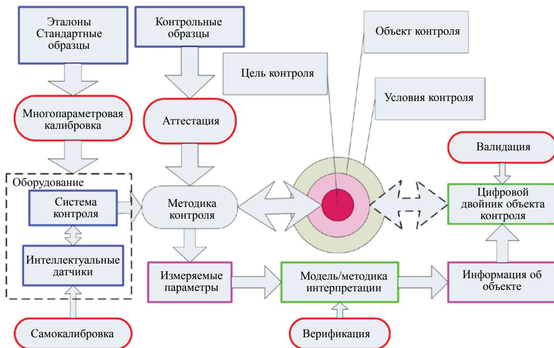
Рис. 22. Общая схема выполнения работ по контролю качества [9, 64].
