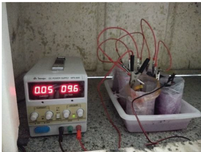
Рис. 3. Система для реалкализации: смесь А — 0,5 А/м 2 .
