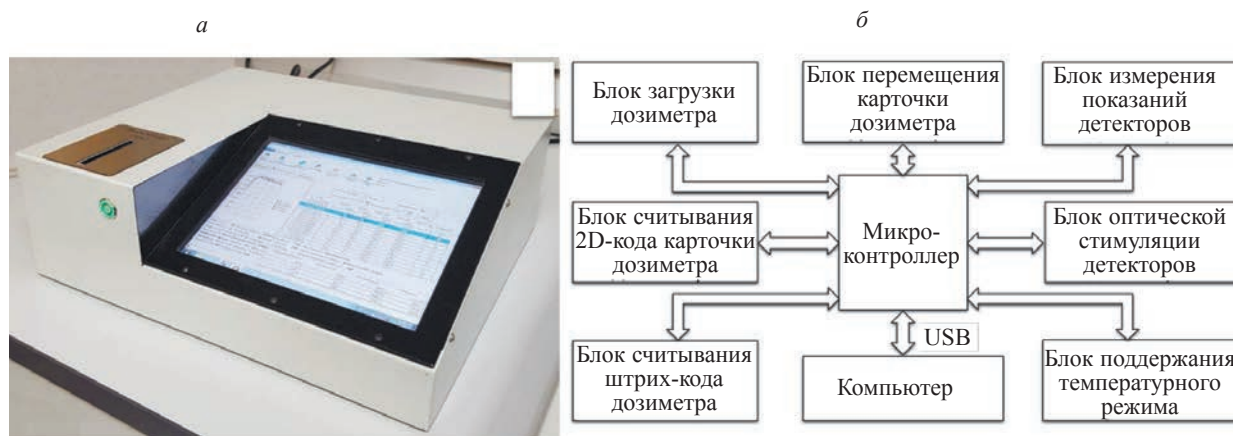
Рис. 1. Общий вид ОСЛ-считывателя КОРОС-333 (а) и его структурная схема (б).
