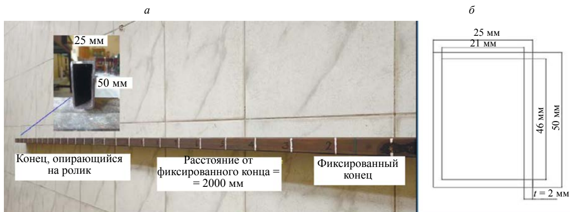
Рис. 3. Образец балки: профильная балка длиной 2000 мм (а); размеры поперечного сечения балки (б).
