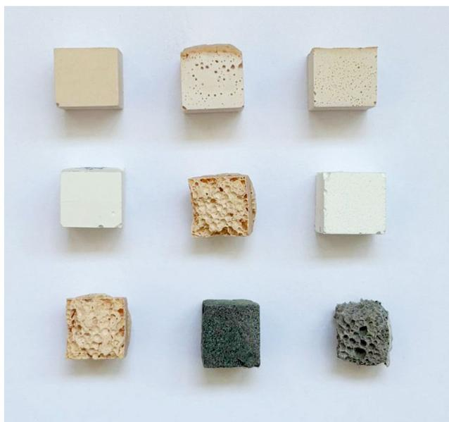
Рис. 1. Геополимерные материалы, полученные на основе природного каолинита, бентонита, золы уноса и синтетического каолинита (материалы авторов).
