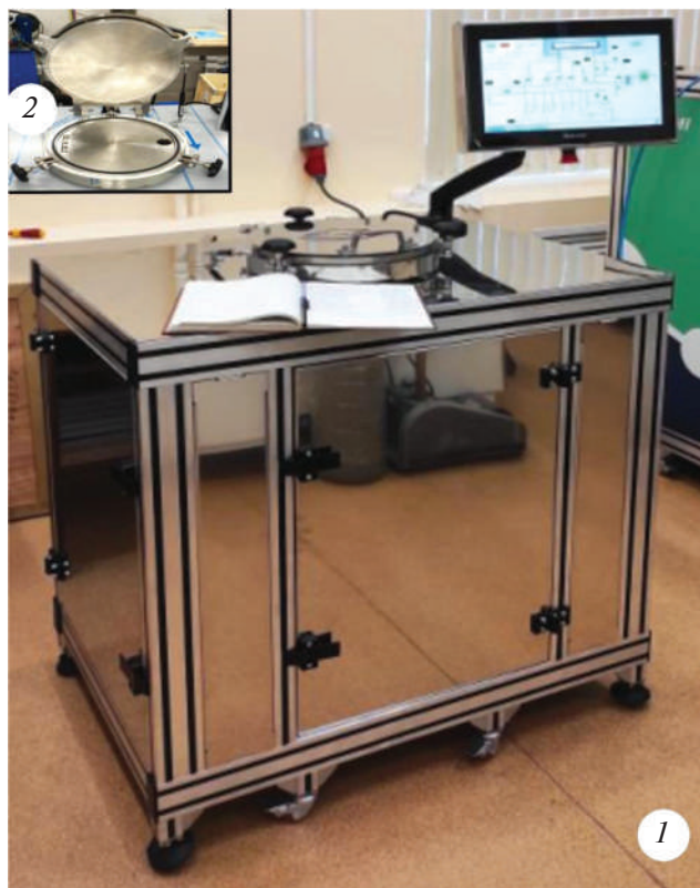
Рис. 7. Установки МН проточно-вакуумного типа с щелевым реактором: 1 – общий вид установки; 2 – щелевой реактор.
