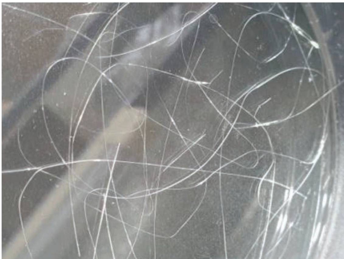
Рис. 5. Фото сформованных вручную полимерных волокон из гафнийоксантирийоксаналюмоксана (табл. 2, образец 4).
