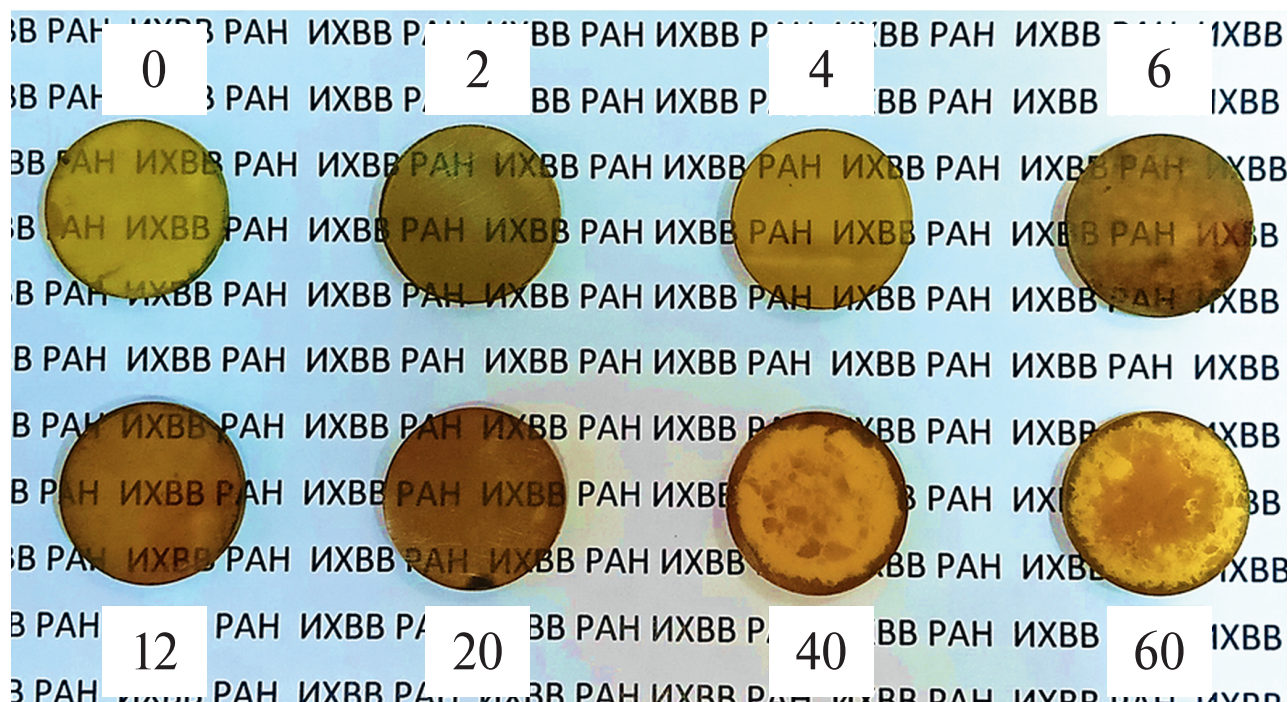
Рис. 4. Внешний вид образцов керамик ZnSe из CVD-порошков с разным временем размола.
