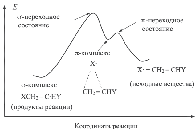
Рис. 1. Качественный механизм радикального присоединения к алкенам.
