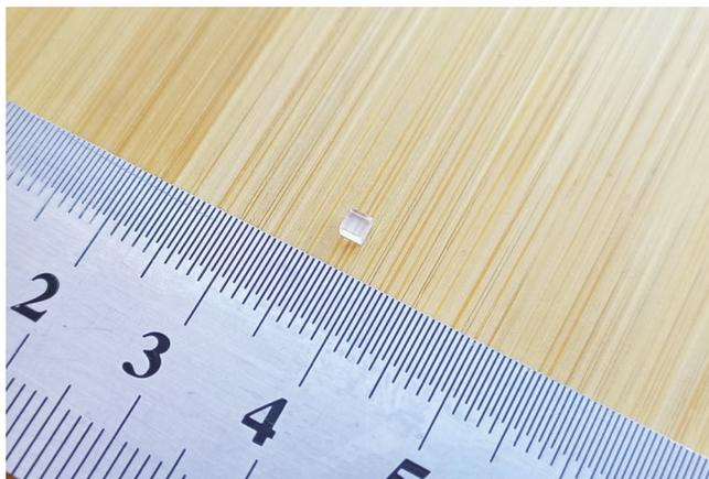
Рис. 1. Монокристаллический образец  $\text{Na}_2\text{W}_2\text{O}_7$ .
