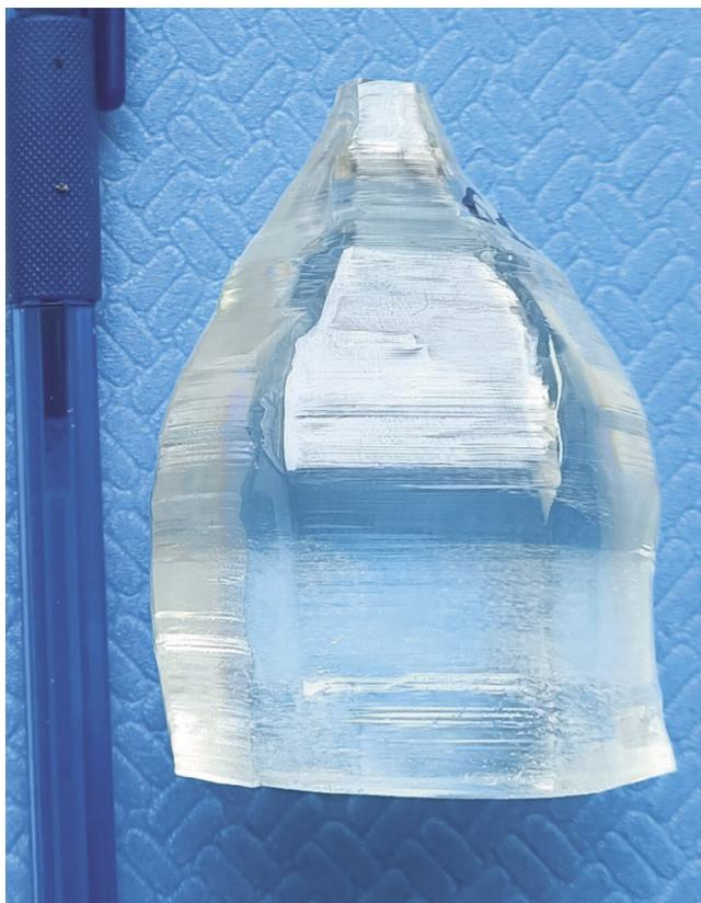
Рис. 1. Монокристалл  $\text{Na}_2\text{Mo}_2\text{O}_7$ .
