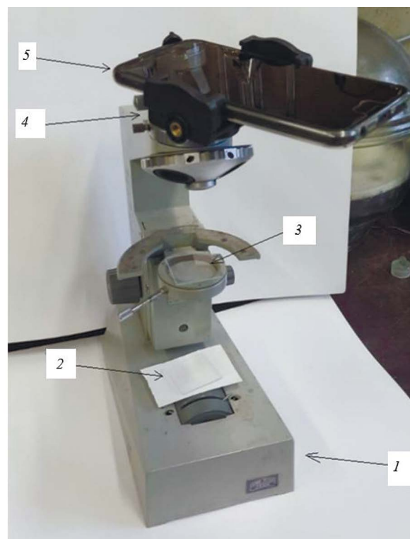
Рис. 2. Установка для измерения цветиметрического сигнала (интенсивности цветовых параметров A_r ) пленок. Пояснения см. в тексте.
