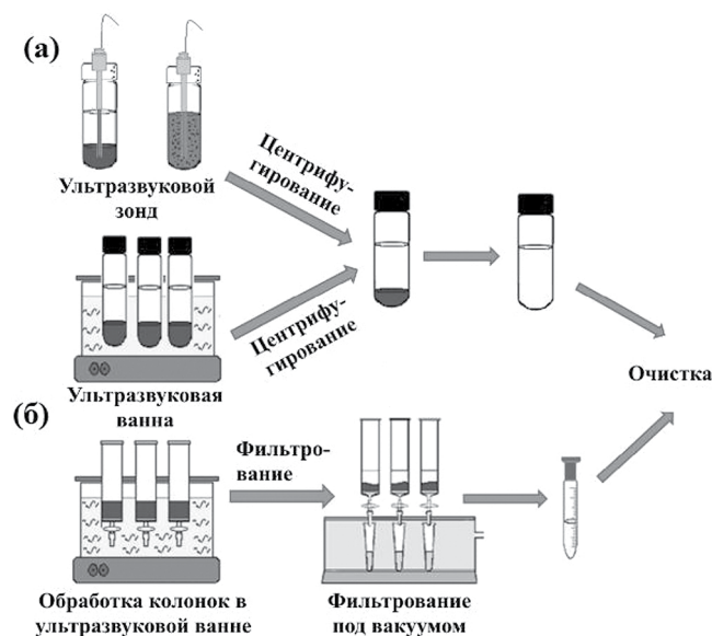
Рис. 1. Схема проведения ультразвуковой экстракции из твердых образцов с использованием ультразвукового зонда (а) или ультразвуковой ванны (б) [80].
