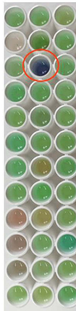
Рис. 1. (а) – Интенсивность зеленого канала (G) на фотографиях планшета с системой краситель–ЦТАБ в присутствии различных лекарственных средств (1 мМ), продолжительность реакции 20 мин; (б) – пример фотографии флуориметрического планшета, ячейка системы с изониазидом отмечена красным.
