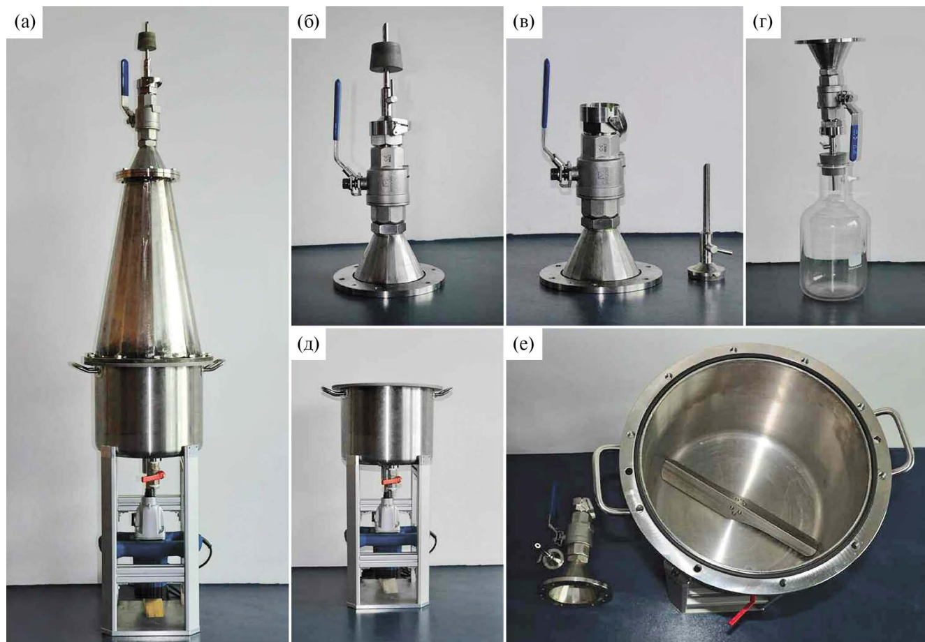
Рис. 5. Фото сепаратора микропластика из донных отложений MPSS. (а) Сепаратор, состоящий из двигателя, приводящего в движение мешалку, контейнера для донных отложений, конической колонны и разделительной камеры со встроенным фильтродержателем и камерой для образца; (б) разделительная камера с установленным фильтродержателем; (в) разделительная камера с отсоединенным фильтродержателем; (г) разделительная камера в режиме фильтрации; (д) стойка, контейнер для донных отложений и двигатель; (е) контейнер для донных отложений с мешалкой.
