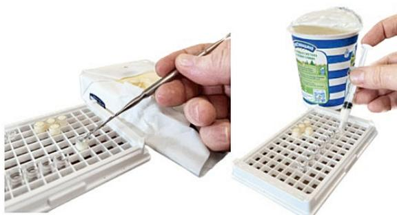
Рис. 2. Заполнение лунок планшета пробами.
