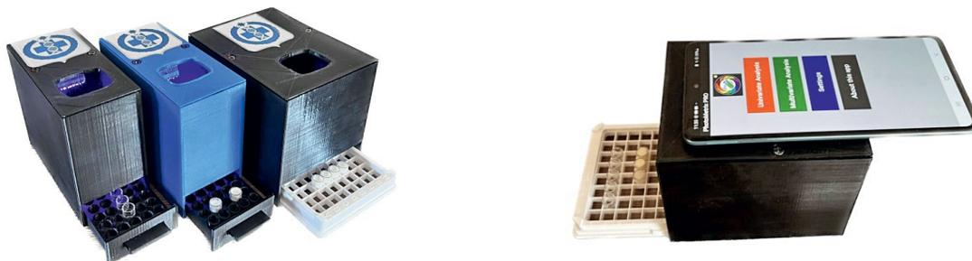
Рис. 1. Устройства для цветометрического анализа.
