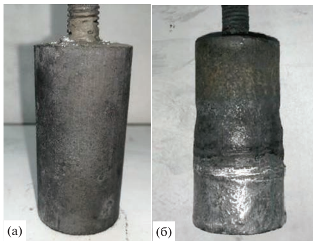
Рис. 10. Внешний вид образца: (а) до испытания на износ; (б) после испытания.
