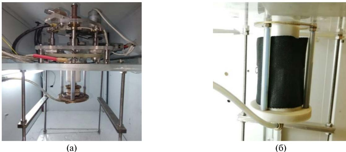
**Рис. 4.** Электроимпульсная установка для получения и одновременного позиционирования наночастиц в углеродную матрицу.
