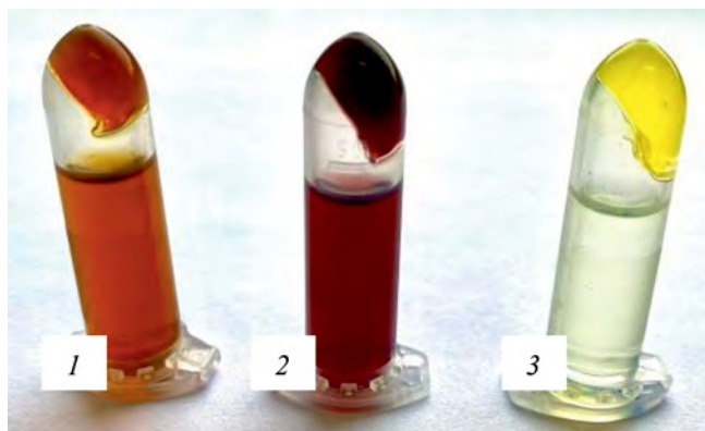
Рис. 6. Фото цветных гелей \text{SiO}_2\text{@NPs} : 1 – \text{SiO}_2\text{@Ag} , 2 – \text{SiO}_2\text{@Au} , 3 – \text{SiO}_2\text{@CdS} . Концентрации \text{SiO}_2 и АОТ в исходных органозолях: 10 мг/мл \text{SiO}_2 и 0.25 М АОТ.
