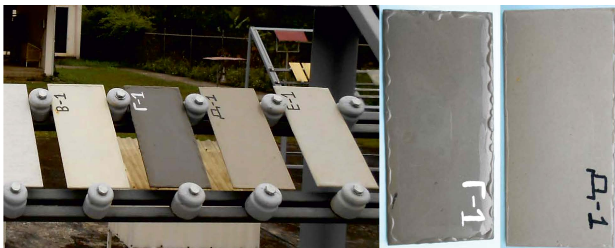
Рис. 5. Внешний вид образцов покрытий составов 6 (обозначение Г-1) и 12 (обозначение Д-1) после 2 месяцев экспозиции на открытом испытательном стенде (Ханой, СР Вьетнам).
