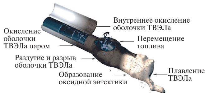
Рис. 1. Плавление ТВЭЛа и сопутствующие процессы в случае АПТ в легководном реакторе [11].
