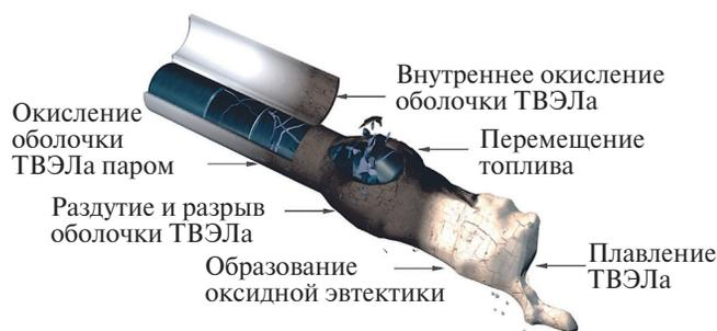
Рис. 1. Плавление ТВЭЛа и сопутствующие процессы в случае АПТ в легководном реакторе [11].
