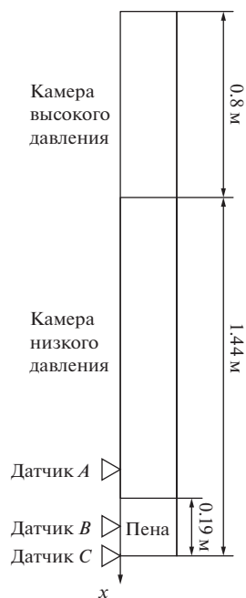
Рис. 2. Схематичная постановка задачи о взаимодействии УВ со слоем пены у стенки.
