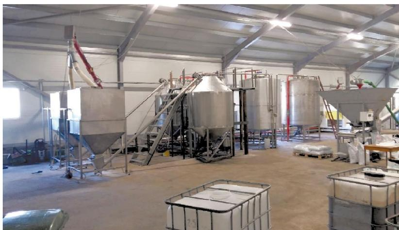
Рис. 3. Технологическая гидромеханическая линия по переработке растительных материалов и природных ресурсов.
