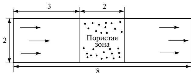
Рис. 2. Расчетная область тестовой задачи (единицы измерения – 1 м).
