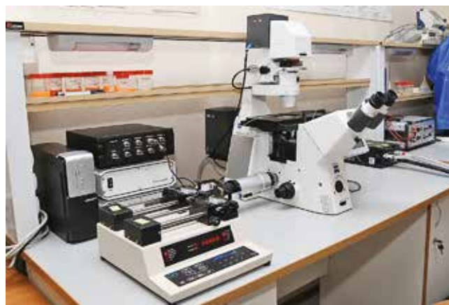
Рис. 1. Экспериментальный стенд для исследования гидродинамики и массообмена в однофазных и двухфазных течениях в микроканальных устройствах.
