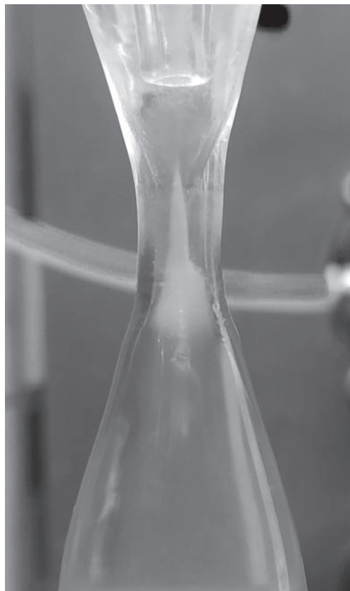
Рис. 8. Кавитация в горловине в микро-ВСА-1 при подключении Т + Т в затопленном аппарате при расходе 6 л/мин.
