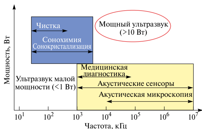
Рис. 2. Классификация ультразвуковых волн в зависимости от частоты и мощности.
