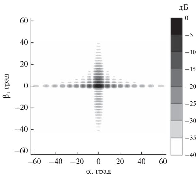
**Рис. 6.** Картограмма ДН прямоугольной ФАР с УБЛ в направлении подстилающей поверхности ниже  $-25.5$  дБ.
