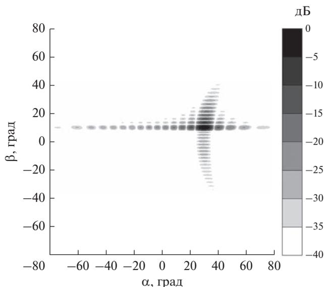
**Рис. 14.** Картограмма ДН прямоугольной ФАР с УБЛ в направлении подстилающей поверхности ниже  $-25.5$  дБ, отклоненной в положение  $30^\circ$  по азимуту,  $10^\circ$  по углу места.
