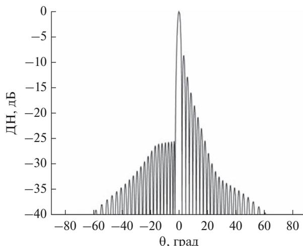
**Рис. 5.** Угломестное сечение ДН линейной ФАР с УБЛ в направлении подстилающей поверхности ниже  $-25.5$  дБ.
