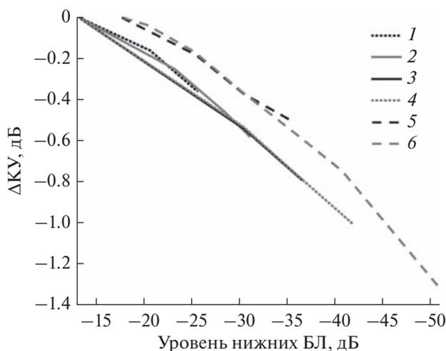
**Рис. 10.** Зависимость снижения КУ ФАР по сравнению с синфазной ФАР от уровня нижних БЛ, для линейных ФАР с разным количеством излучателей: 15 (1), 30 (2), 60 (3), 120 (4), и круглых ФАР с диаметром  $10\lambda$  (5) и  $20\lambda$  (6).
