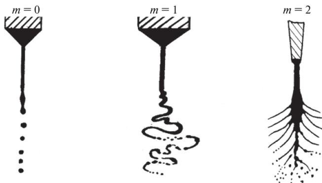
Рис. 1. Зарисовки режимов электродиспергирования жидкости в различных азимутальных модах по результатам экспериментов [23].
