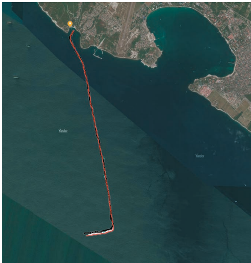
Рис. 1. Трасса движения научно-исследовательского судна “Ашамба” при размотке кабеля (черная линия) и фактическое положение кабеля на дне, определенное в ходе обработки сейсмических данных водной волны (красная линия).
