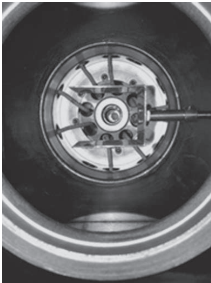
Рис. 8. Фотография области влета пучка в ионизатор. Видна заслонка для перекрытия пучка, укрепленная на вводе вращения.
