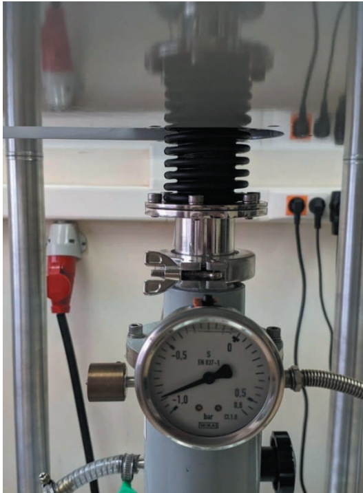
Рис. 3. Внешний вид гофрированной резиновой манжеты (позиция b на рис. 1), обеспечивающая вакуумное соединение криостата и верхней части штока. Давление гелия в шахте криостата 0.1 атм. Манжета не прижимается к внутренней вставке и не передает вибрации на шток с образцом благодаря установленным металлическим кольцам внутри.
