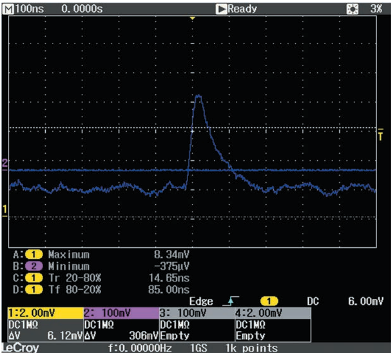
Рис. 6. Осциллограмма трехэлектронного импульса.
