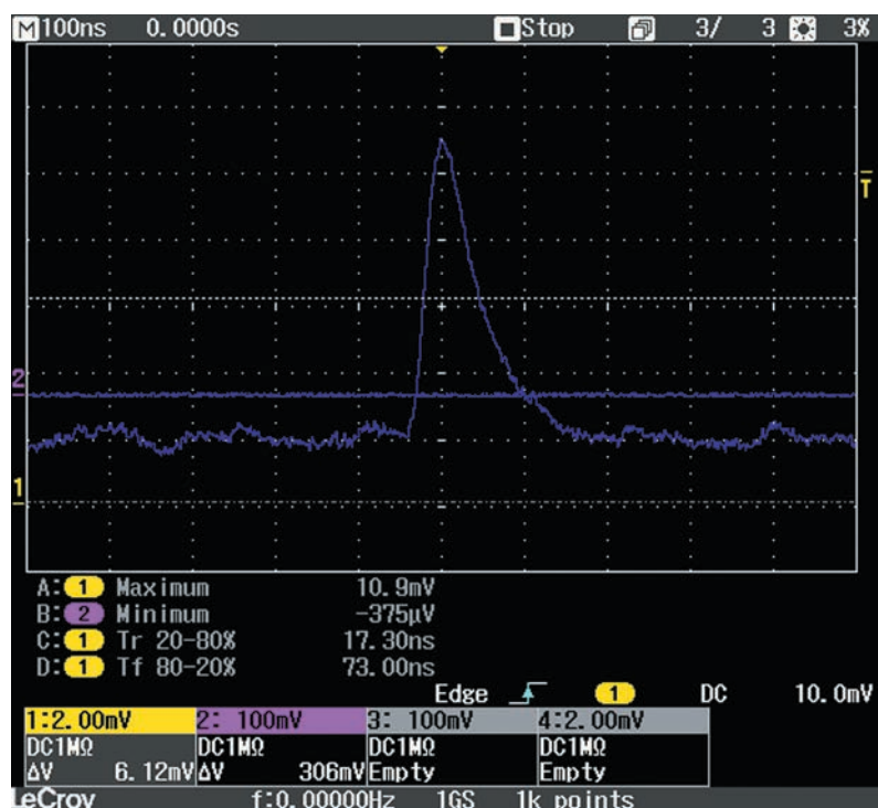
Рис. 7. Осциллограмма импульса от космического излучения.
