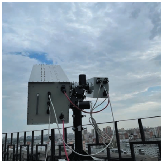
Рис. 6. Измерение яркостной температуры неба на крыше главного корпуса ИПФ РАН, г. Нижний Новгород.
