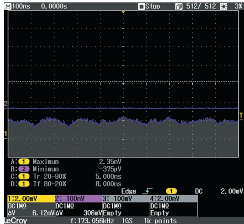
Рис. 3. Осциллограмма собственного шума детектора.
