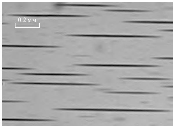
Рис. 5. Фотография капельных агрегатов, вытянутых в постоянном магнитном поле. Напряженность магнитного поля равна 20 кА/м.
