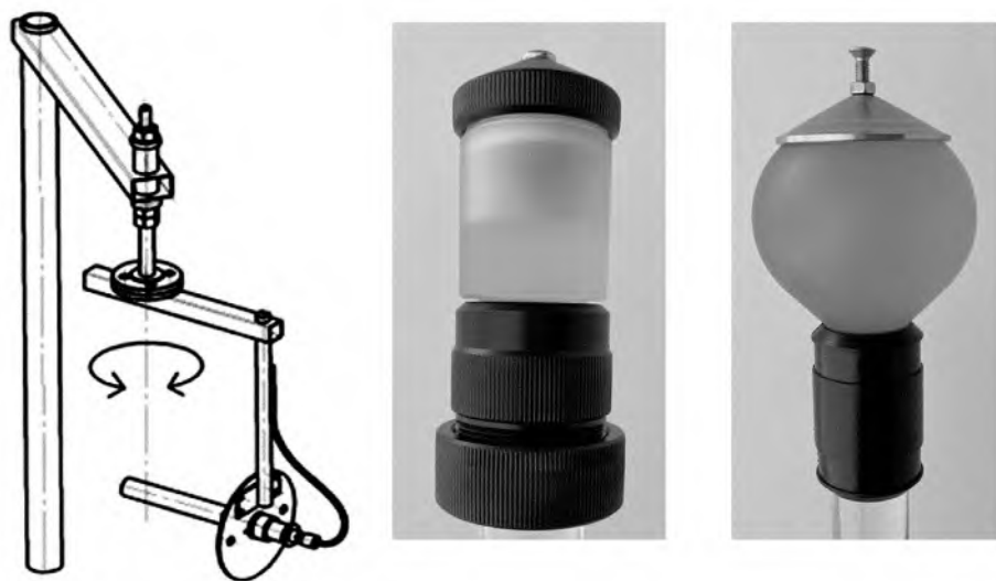
Рис. 4. Схема стенда для исследования угловых характеристик излучателей (слева), фотографии конусного и сферического излучателей (справа).
