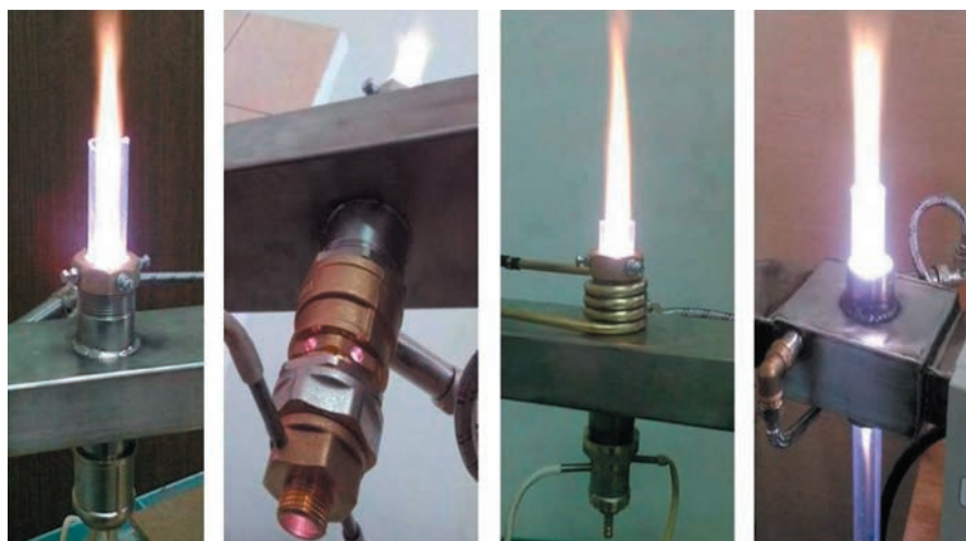
Рис. 2. Простой СВЧ-плазматрон на стандартной резьбовой латунной арматуре.
