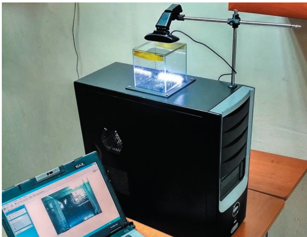
Рис. 4. Фотография портативной камеры Вильсона.
