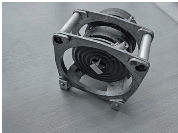
Рис. 5. Приспособление для обеспечения движения тестового образца.
