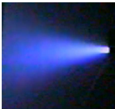
Рис. 1. Генерация э.п.п. воздуха в свободном объеме; P_m = 5.0 Торр.
