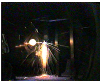
Рис. 2. Облако аэрозольных частиц \text{Al}_2\text{O}_3 в электронно-пучковой плазме воздуха при P_m = 1.0 Торр.
