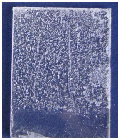
Рис. 7. Изменение рельефа поверхности пластины из полиметилметакрилата в результате воздействия э.п.п. кислорода: сверху – обработанная часть образца, снизу – контрольная (необработанная) часть.
