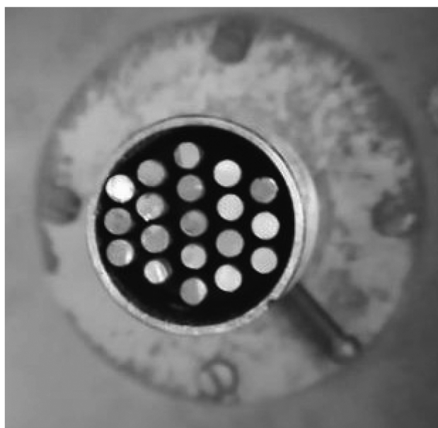
Рис. 2. Фотография детектора с 19 коллекторами.
