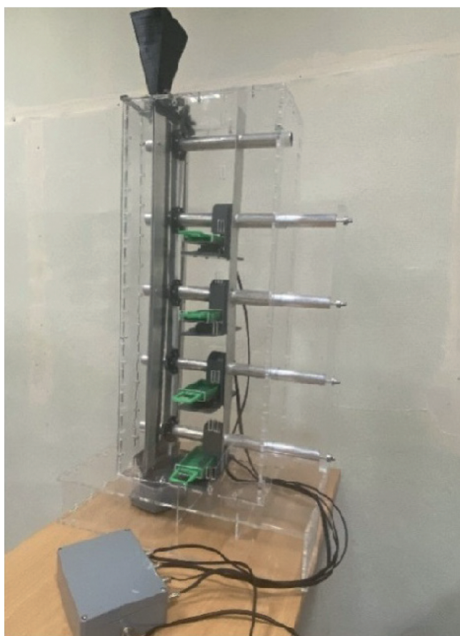
Рис. 1. Фото прибора-анализатора с четырьмя магнитоактивными блоками для контроля содержания магнитоактивных частиц в сыпучей среде.
