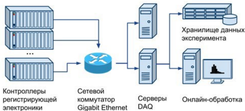
Рис. 9. Архитектура системы сбора данных эксперимента СПАСЧАРМ.
