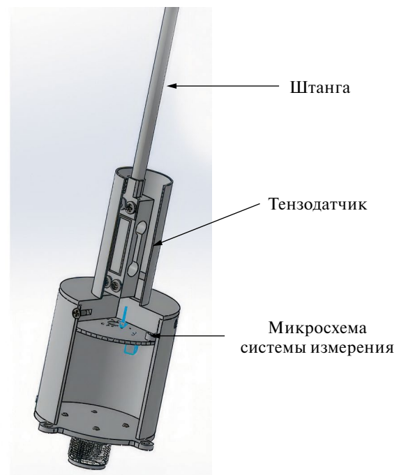
Рис. 11. 3D-модель угломера с указанием основных элементов.
