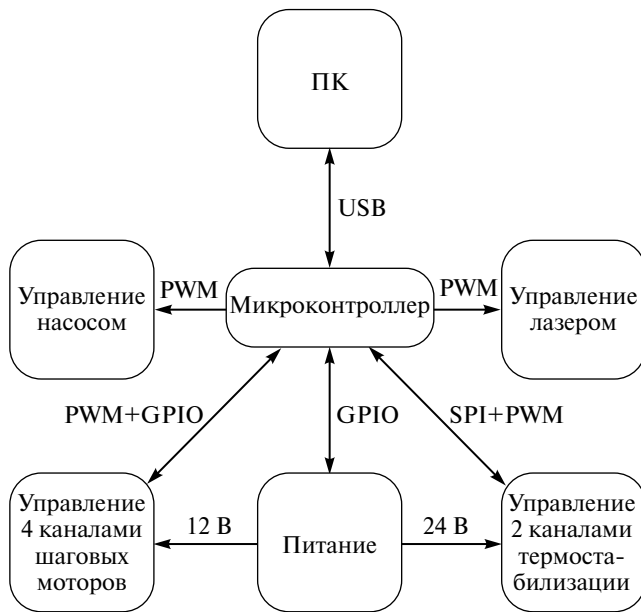
Рис. 2. Структурная схема контроллера ПГС.
