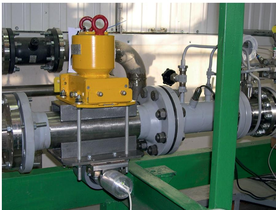
Рис. 9. Внешний вид макета двухизотопного  $\gamma$ -плотномера DN 100 во время испытаний на стенде многофазных потоков ГЭТ195-2011, ВНИИР (г. Казань).
