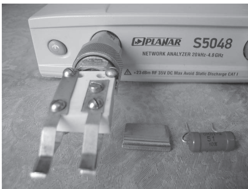
Рис. 2. Аксессуар для присоединения к коаксиальному входу прибора двухполюсных объектов: электронных компонентов навесного монтажа или двухполюсных измерительных ячеек с образцами, максимальный размер которых превышает 1 см. Рядом толстая пластина, обеспечивающая функцию режима КЗ. Калибровочной нагрузкой 50 Ом служит резистор типа ОМЛТ-2 51 Ом ( \pm 10\% ) с измеренным сопротивлением 50.2 Ом. Режим XX обеспечивается конструкцией переходника.
