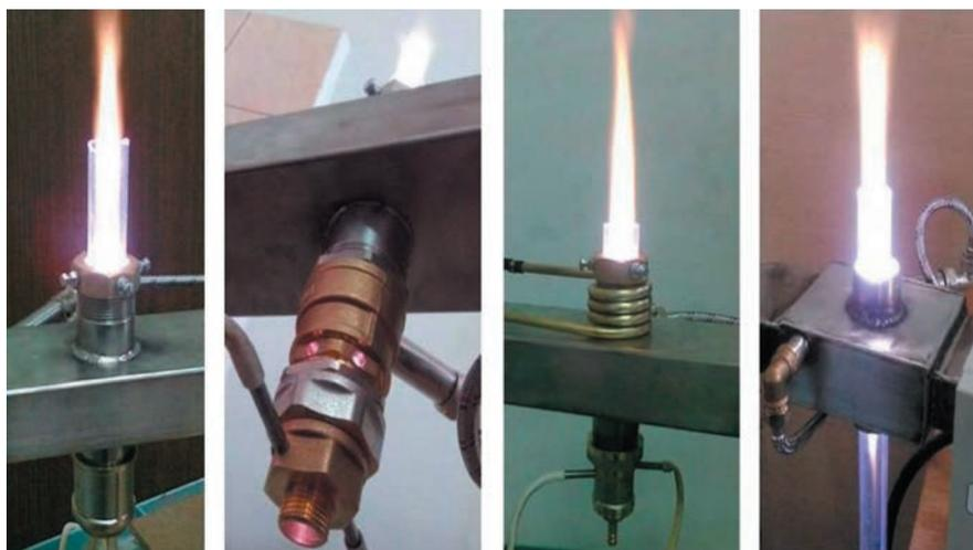
**Рис. 2.** Простой СВЧ-плазмотрон на стандартной резьбовой латунной арматуре.
